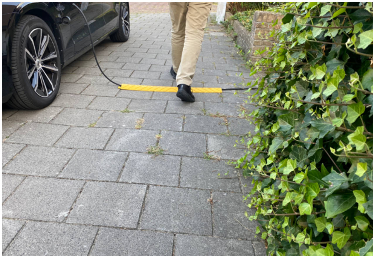
Particulier laden van een stoepgeparkeerde auto in de openbare ruimte met behulp van een ongewenste kabelbrug
